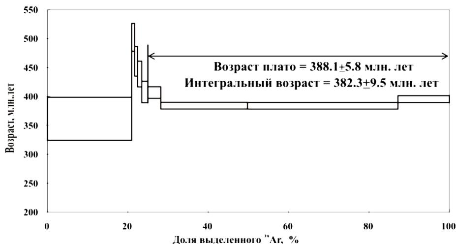
Рис. 12. Результаты  $^{40}\text{Ar}/^{39}\text{Ar}$  исследования методом ступенчатого прогрева монофракции амфибола из дайки 99-1 южного обрамления Хибинского массива.
