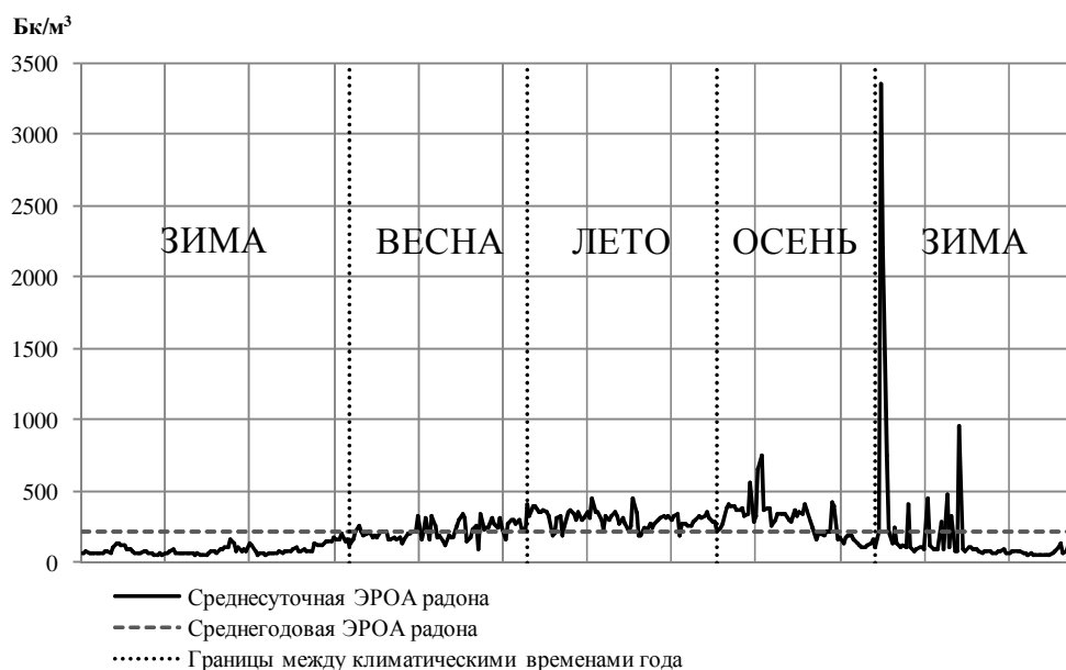
Рис. 1. ЭРОА радона в 2012 г. на основе данных мониторинга ОА радона на контрольно-калибровочном пункте в БФ «Сосновгеология».
