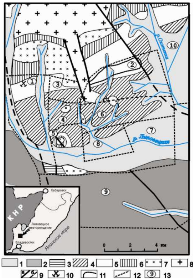
Рис. 3.3. Схема геологического строения Липовецкого каменноугольного месторождения [Угольная база ..., 1997]: 1 – четвертичные отложения, 2 – неогеновые отложения; 3 – отложения коркинской серии; 4 – отложения галенковской свиты; 5 – отложения липовецкой угленосной свиты; 6 – отложения уссурийской свиты; 7 – поздне меловые (?) андезиты, дациты и диориты; 8 – ордовикские (?) граниты; 9 – крупные тектонические нарушения; 10 – стволы шахты № 4; 11 – площадь действующего разреза; 12 – границы участков месторождения; 13 – номера участков (1–10): 1 – поле шахты № 4; 2 – разрез Восток-2; 3 – Восточный; 4 – Южный-2; 5 – Липовецкий-6; 6 – Южный-3; 7 – Галенковский-3; 8 – Некковский; 9 – Галенковский-2; 10 – Галенковский-1
