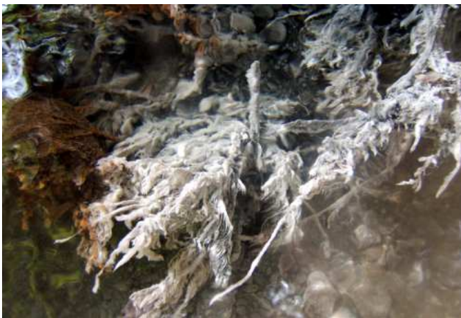
Рис. 3.43. Выход вод техногенного комплекса шахты «Мгачи» в русло р. Мальй Сертунай (левый борт). Образование сульфатов и гидроксида железа
