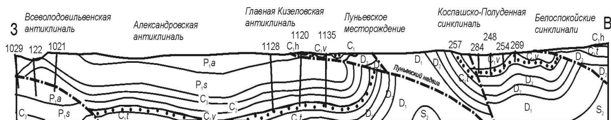
Рис. 5.10. Геологический разрез Кизеловского каменноугольного района (бассейна) (по Г.С. Калмыкову) [Геология угольных месторождений СССР, 1990]: P_1a – артинские песчаники, аргиллиты, конгломераты; P_1s – сакмарские кремнистые известняки; C_3 – окремненные доломиты; C_2 – известняки, глинистые и известковистые сланцы, песчаники, глины; C_{1v} – визейские известняки и доломиты; C_1h – кварцевые песчаники, алевролиты, аргиллиты, угли; C_1 – известняки, аргиллиты, песчаники; D_3 – известняки, кремнистые сланцы, песчаники, железные руды; D_2 – известняки, кварцевые песчаники; D_1 – песчаники, сланцы; S_2 – верхнесилурийские известняки, песчаники, сланцы
